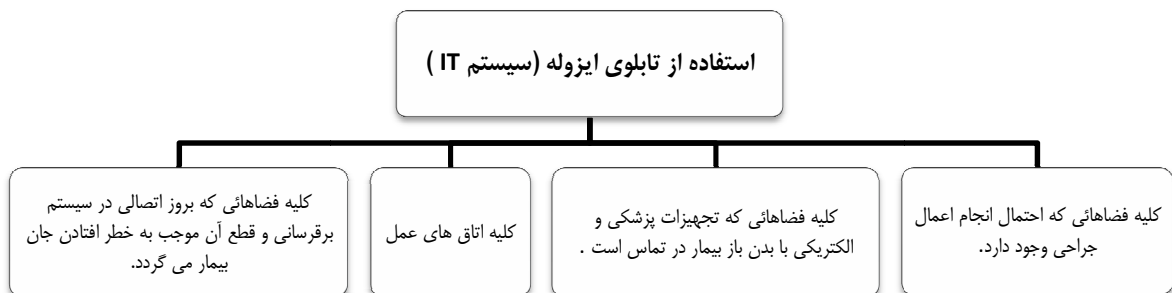
شکل ۵-۲- استفاده از تابلوی ایزوله (سیستم IT)
